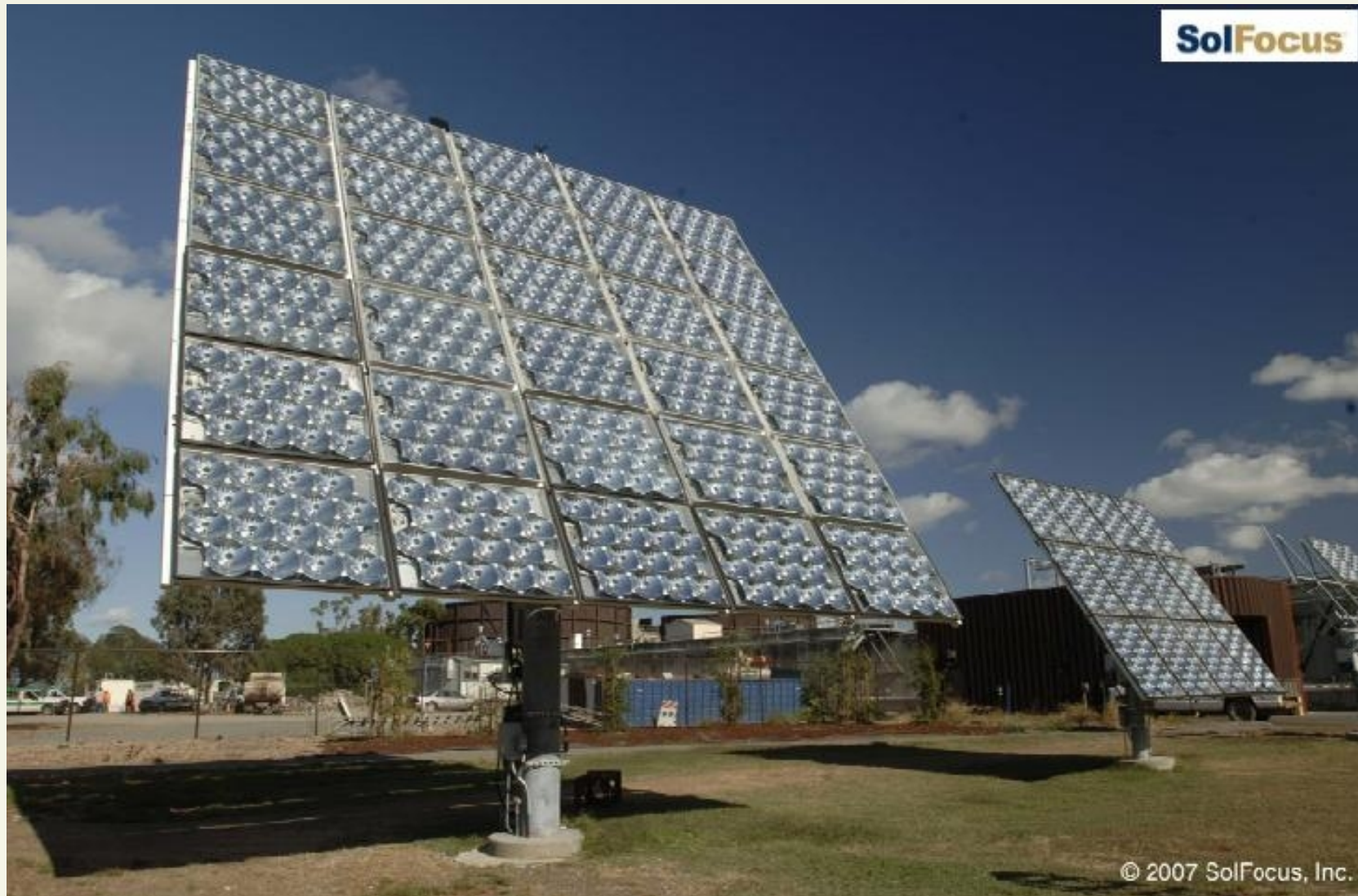
Sistema Cassegrain - Esternamente simile ai rifrattivi
